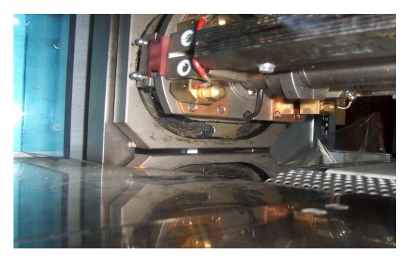
La testa taglia-salda di tipo "LongDwell" consente un maggior contatto di saldatura con il film in termini di tempo ed è usata principalmente nel settore delle flow pack orizzontali e verticali.
